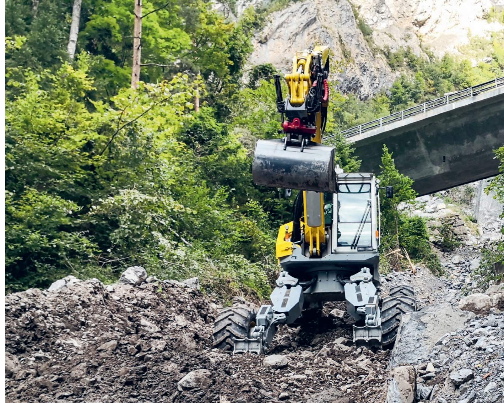
Die Pioneer Fellows Dominic Jud und Burak Çizmeci wollen ferngesteuerte und teilautonome Baumaschinen auf den Markt bringen. Erste Testversuche (im Bild in Sisikon) verliefen vielversprechend.
